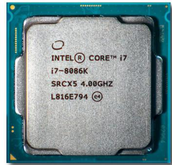
Unter dem Heatspreader des Core i7 8086K befindet sich wie im Falle des Core i7 8700K Wärmeleitpaste statt Indium Lot, was das Übertakten potenziell erschwert.
