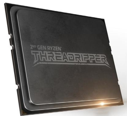
Mit der zweiten Threadripper-Generation steigt die maximale Kernzahl von 16 auf 32 Kerne an.
