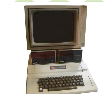
Mit optionalem Monitor und Diskettenlaufwerken kam der 1977er Apple II dem späteren IBM-PC schon sehr nahe.
