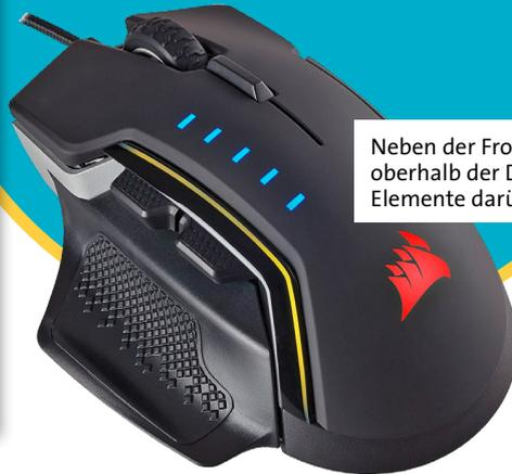
Neben der Front sind auch das Corsair-Logo sowie der Streifen oberhalb der Daumentasten per RGB-LEDs beleuchtet. Die fünf Elemente darüber zeigen die derzeit gewählte DPI-Stufe an.
