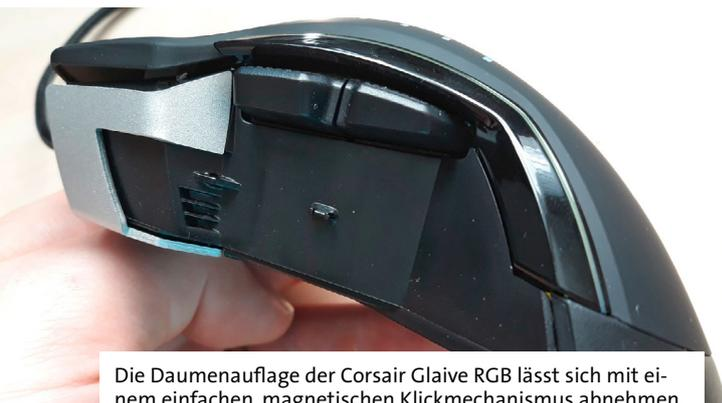
Die Daumenauflage der Corsair Glaive RGB lässt sich mit einem einfachen, magnetischen Klickmechanismus abnehmen.
