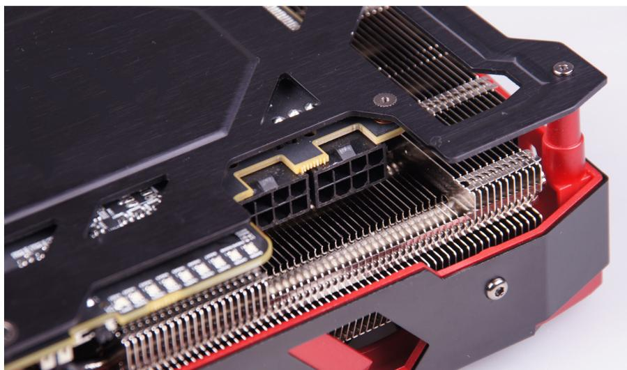
Der Zugang zu den beiden für den Betrieb benötigten 8-Pol-Stromanschlüssen der RX Vega 56 Red Devil ist extra ausgespart, deshalb aber auch etwas schwerer zu erreichen.
