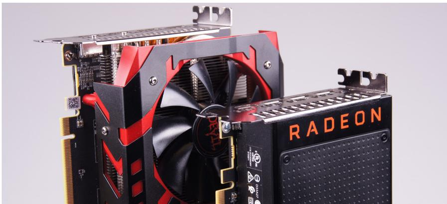
Die Größe der RX Vega 56 Red Devil wird spätestens im Vergleich mit dem Referenzmodell von AMD deutlich: Powercolors Custom Design ist fast drei Zentimeter länger.
