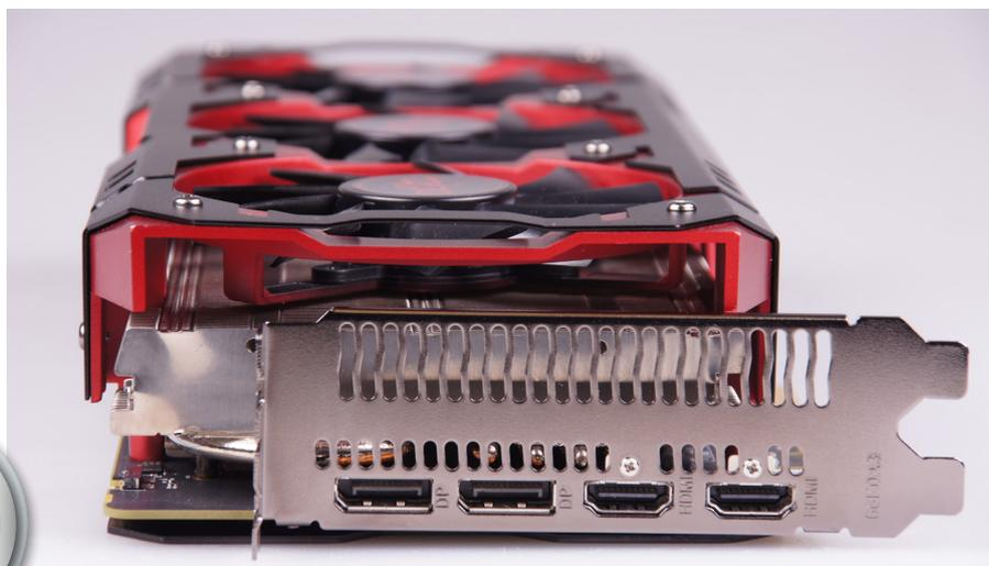
Die RX Vega 56 Red Devil besitzt jeweils zwei DisplayPort-1.4- und HDMI-2.0b-Anschlüsse. Sie misst 29,5 x 13,9 x 5,9 cm (LxBxH) und belegt entsprechend drei Slots im Gehäuse.
