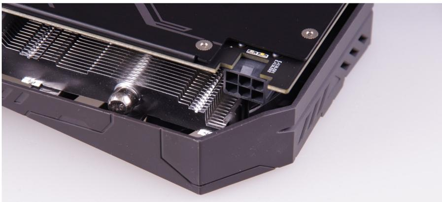
Das Custom Design besitzt einen zusätzlichen 6-Pol-Stromanschluss, damit kann die Grafikkarte theoretisch bis zu 150 Watt Strom aufnehmen.
