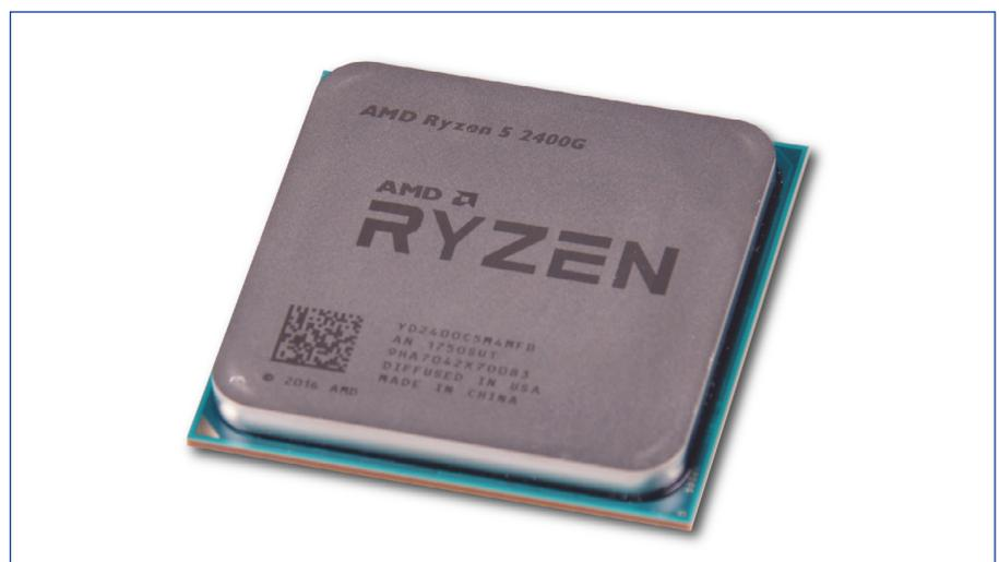
AMDs neue Ryzen-APUs setzen wie die anderen Ryzen-Modelle auf den Sockel AM4. Zwischen dem hier zu sehenden Heatspreader und dem darunterliegenden Die der CPU befindet sich allerdings Wärmeleitpaste statt wie bisher Flüssigmetall, das niedrigere Temperaturen ermöglicht.
