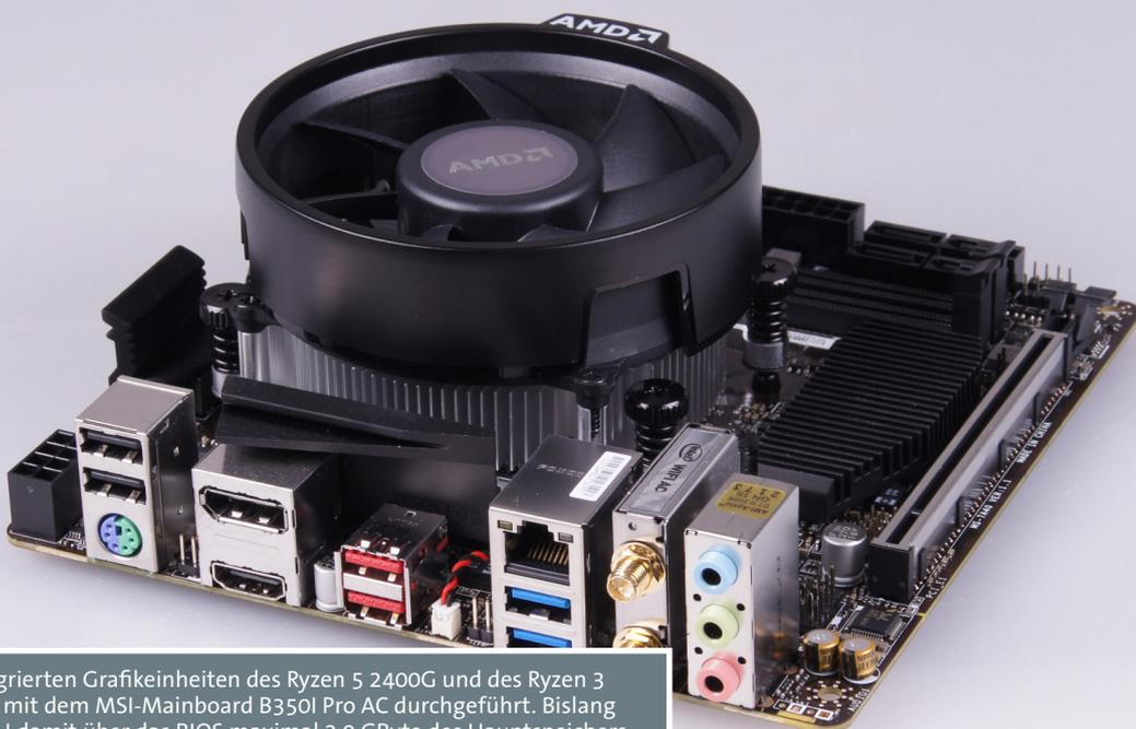
Die Tests der integrierten Grafikeinheiten des Ryzen 5 2400G und des Ryzen 3 2200G haben wir mit dem MSI-Mainboard B350I Pro AC durchgeführt. Bislang kann man der APU damit über das BIOS maximal 2,0 GByte des Hauptspeichers zuweisen, mit zukünftigen BIOS-Versionen sollen bis zu 8,0 GByte möglich sein.
