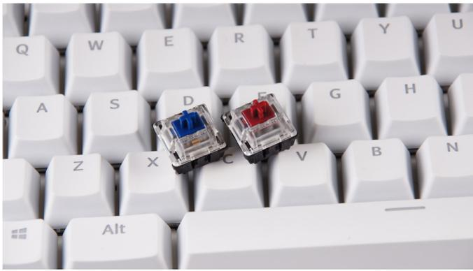
Tesoro bietet die SE Spectrum mit zwei Schalter-Varianten an: Blaue mit klickendem Feedback und rote lineare Taster ohne Klickgeräusch.
