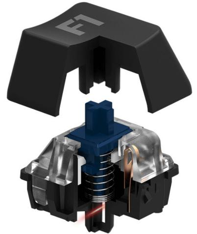
Die optischen Switches sind mit einem Infrarotsensor bestückt. Beim Herunterdrücken der Taste wird der Infrarotstrahl unterbrochen und die Taste dadurch ausgelöst.
