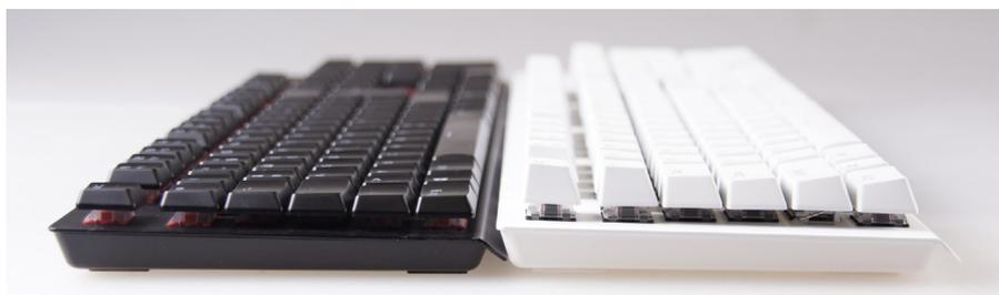
Der Vorgänger ohne »SE«-Zusatz setzt auf das gleiche Gehäuse, aber flachere und mit mechanischen Agile-Switches statt der optischen Schalter bestückte Tasten.
