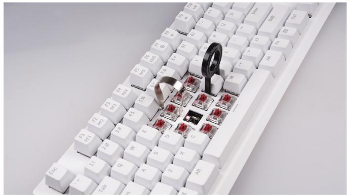
Im Lieferumfang sind zwei Werkzeuge enthalten: eines, um die Kapfen zu entfernen, und eines für das Austauschen der Switches darunter.
