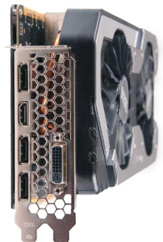
Die GTX 1070 Ti Jetstream verfügt über drei DisplayPort-1.4- sowie jeweils einen HDMI-2.0b- und DVI-Anschluss. Die 28,5 cm lange Grafikkarte belegt drei Slots im Gehäuse.
