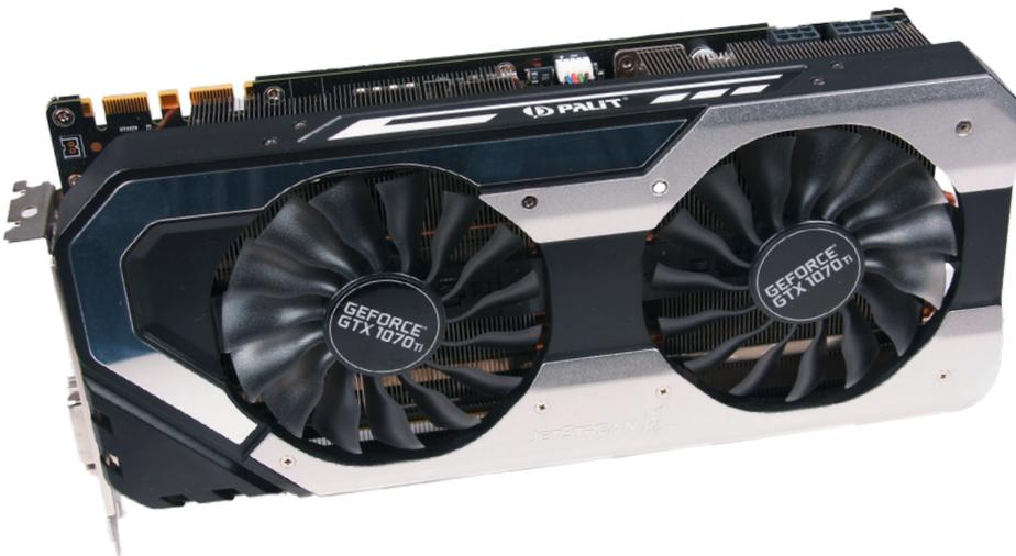
Palit nutzt bei der GeForce GTX 1070 Ti bewährte Technik: Die wuchtige Kühlung sitzt auf allen GTX-1000-Modellen der Jetstream-Reihe und zeichnet sich durch gute Messwerte aus.
