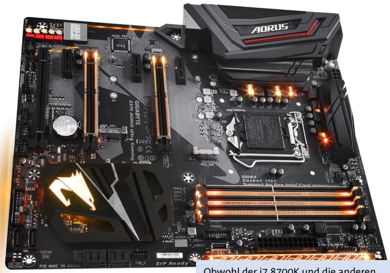
Obwohl der i7 8700K und die anderen Coffee-Lake-Modelle genau wie der Vorgänger auf den Sockel 1151 setzen, ist für den Betrieb ein neues Mainboard mit 300er-Chipsatz nötig. Zum Release sind nur Boards mit Z370-Chipsatz verfügbar.
