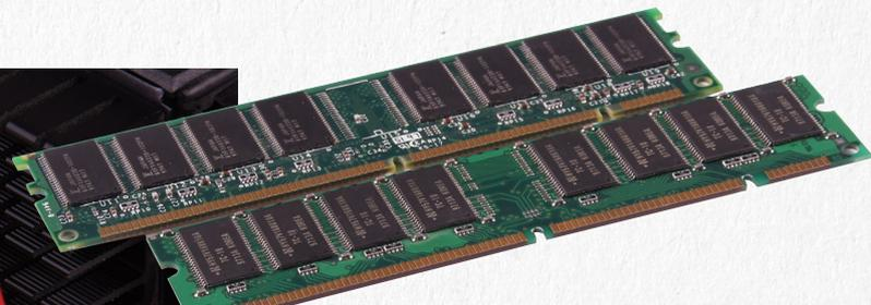
Die SDRAM-Module takten mit 66 MHz und besitzen eine Zugriffszeit von 10 Nanosekunden. Ihre Betriebsspannung beträgt 3,3 Volt.
