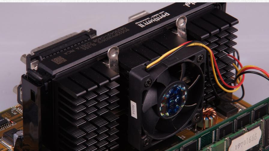
Der Intel Pentium II alias Deschutes taktet mit 333 MHz und wurde in 250 Nanometern gefertigt. Der High-End-Prozessor kostet 1997 über 1.500 Mark.
