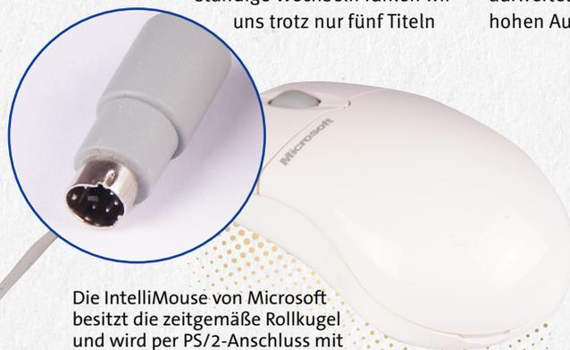
Die IntelliMouse von Microsoft besitzt die zeitgemäße Rollkugel und wird per PS/2-Anschluss mit dem Rechner verbunden.
