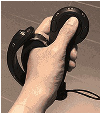
Valves neue VR-Controller werden mittels eines Bandes über den Handrücken befestigt – das erlaubt virtuelles Greifen mit den Fingern, da der Controller nicht ständig festgehalten werden muss.
