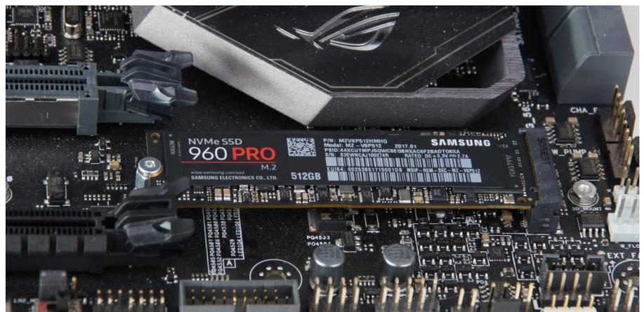
M.2-SSDs wie die Samsung SSD 960 Pro werden im entsprechenden Mainboard-Slot mit einer Schraube fixiert. Kabel für den Datentransfer oder die Stromversorgung entfallen komplett.
