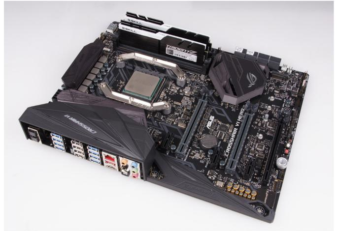
Für den Test von Ryzen hat AMD uns das hier zu sehende Asus Crosshair VI Hero und das Aours AX370 Gaming 5 von Gigabyte mit dem für Ryzen nötigen Sockel AM4 zur Verfügung gestellt. Die Messungen haben wir mit dem neuesten BIOS auf dem Gigabyte-Board durchgeführt.
