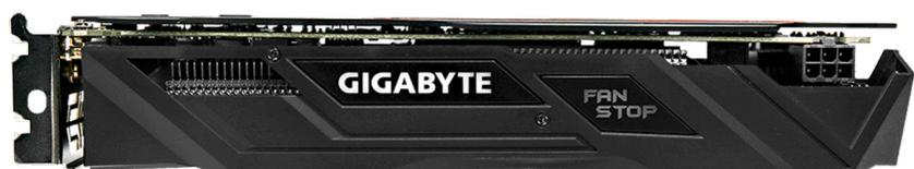
Die Gigabyte GTX 1050 Ti G1 Gaming verfügt über einen 6-Pin-Stromanschluss. Der ist für die GTX 1050 Ti keine Pflicht, prinzipiell genügt ihr die Stromversorgung per PCI Express-Slot.
