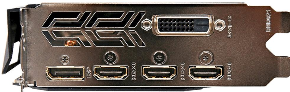
Gleich drei HDMI-2.0b-Ports stehen zur Verfügung. Außerdem sind jeweils ein DualLink-DVI-Anschluss und eine DisplayPort-Buchse (Version 1.4) vorhanden.
