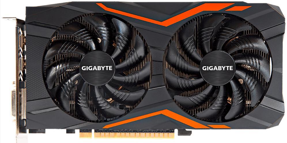
Die Kühlung übernehmen im Falle der GTX 1050 Ti G1 Gaming zwei Axial-Lüfter mit einem Durchmesser von jeweils 90 Millimetern, die im Leerlauf stillstehen.
