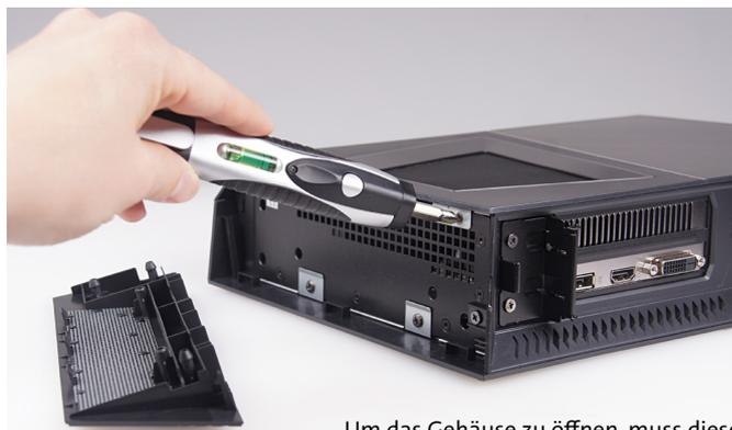
Um das Gehäuse zu öffnen, muss diese seitliche Abdeckung mit ausreichend Hebelwirkung entfernt werden, außerdem sind noch zwei Schrauben zu lösen.
