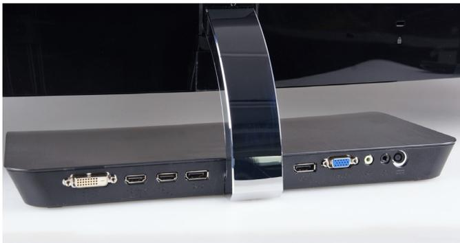
Fast alles da, was man braucht: ein DVI-Port, zwei HDMI-Anschlüsse, zwei DisplayPorts, ein VGA-Anschluss, ein Audio-Eingang für die integrierten Lautsprecher und ein Audio-Ausgang zum Anschluss von Kopfhörern.
