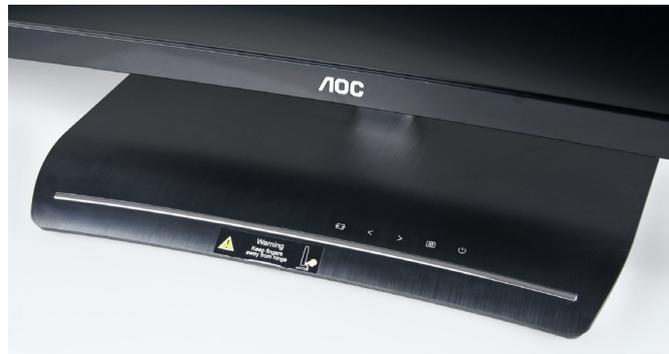
Die Bedienung des Monitormenüs erfolgt über diese berührungsempfindlichen Oberflächen im Standfuß, echte Tasten mit haptischem Feedback wären uns allerdings lieber.
