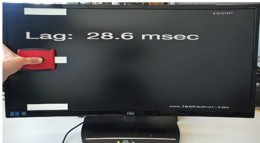
Die Messung des Input Lags nehmen wir mit dem »Video Signal Input Lag Tester« von Leo Bodnar vor. Am mittleren Balken liegen die Werte etwas niedriger als am unteren, da das Bild bei LCD-Monitoren von oben nach unten aufgebaut wird.
