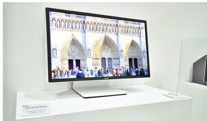
Der TFT-Prototyp mit 27 Zoll Diagonale von Sharp beherrscht 8K-Auflösung, HDR und 120 Hertz Bildwiederholrate (Bildquelle: PC Watch).
