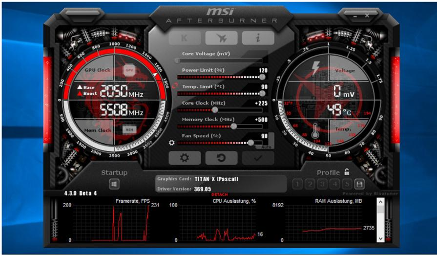
Mit erhöhtem Power- und Temperatur-Limit sowie deutlich aggressiverem Lüfter lässt sich die Titan X stabil auf über 2,0 GHz bringen und leistet dann nochmal gut 10 Prozent mehr.
