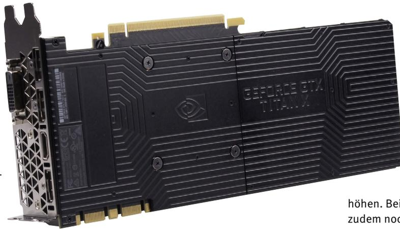
Anders als die erste GTX Titan kommt die neue Titan X mit einer Backplate. Die lässt sich auch abnehmen, um den Luftfluss in einer SLI-Konfiguration zu verbessern – das wären dann 2.600 Euro nur für die zwei Titan-X-Grafikkarten.
