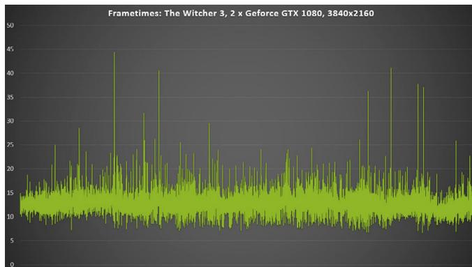
Eine einzelne GTX 1080 erreicht in unserem Benchmark von The Witcher 3 ungefähr 80 fps in WQHD, die Frametimes sind dabei bis auf einige leichte Ausreißer recht gleichmäßig (linkes Bild). Zwei GTX 1080 im SLI-Verbund kommen sogar in 4K noch auf fast 80 fps, den etwas größeren Abständen bei den Frametimes stehen gleichzeitig weniger Ausreißer gegenüber (rechtes Bild).
