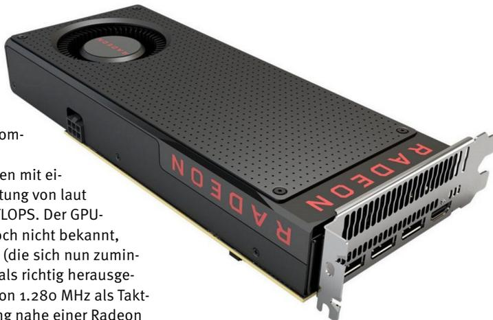
Die Radeon RX 480 ähnelt äußerlich stark den Vorgängermodellen, soll dank 14-nm-Fertigung aber erheblich weniger Energie für die gleiche 3D-Leistung wie eine R9 390X benötigen und spürbar günstiger werden.
