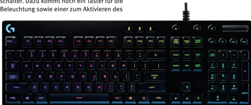
Das Gehäuse der Logitech G810 beschränkt sich auf die für die Tasten nötige Grundfläche. (Hinweis: Das Foto stammt von der US-Version mit halbhoher Enter-Taste, die deutsche Variante hat die gewohnte Enter-Taste mit doppelter Bauhöhe.)
