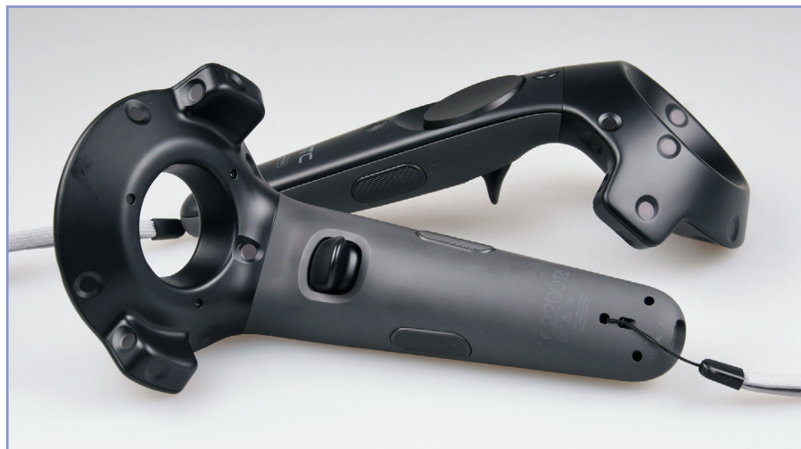
Der HTC Vive liegen direkt zwei Controller bei. Deren Sensoren fangen das Laser-Licht der Lighthouse-Tracker auf und erlauben so sehr präzises und direktes Steuern in der VR.
