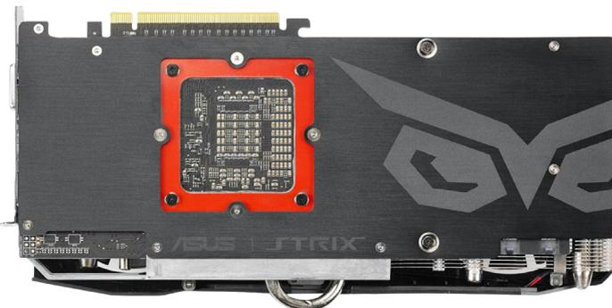
Das Strix-Motiv findet sich auch auf der Backplate. Die Aussparung über der GPU verbessert die Kühlung, ein roter Rahmen erhöht die Stabilität.
