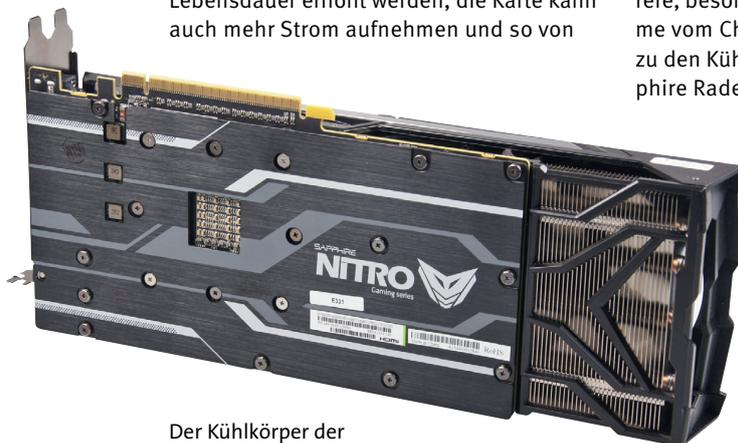
Der Kühlkörper der Sapphire Radeon R9 Fury Nitro ragt weit über das PCB inklusive Backplate hinaus. Sowohl die Nitro als auch die Asus-Strix passen mit über 30 cm Länge nur in große Gehäuse.
