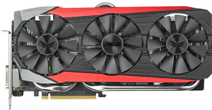
Auch die Fury-Strix setzt auf ein ausladendes Kühlsystem. Drei Lüfter, Heatpipes und ein großer Kühlkörper halten die Temperaturen niedrig.
