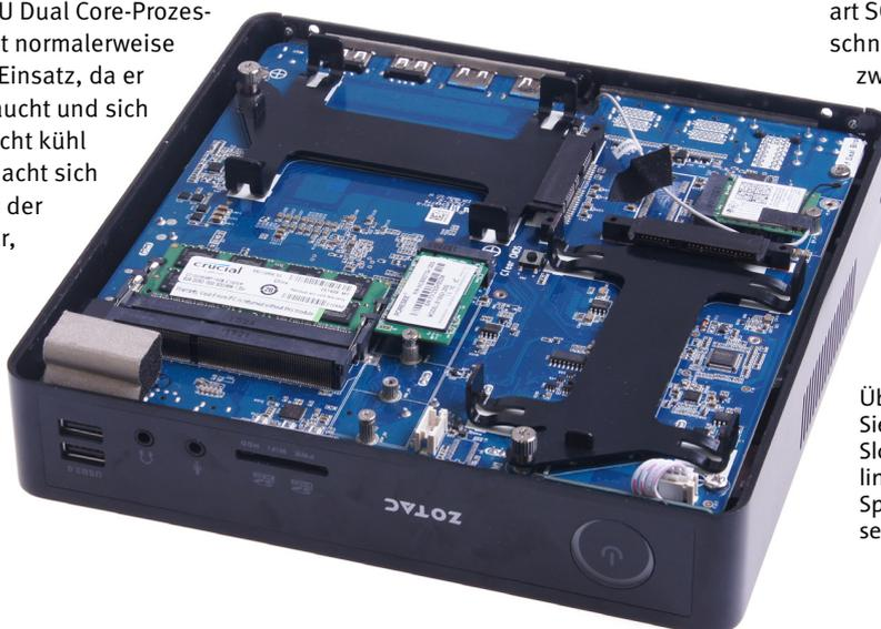
Über die leicht entfernbar Unterseite haben Sie bei der ZBOX Zugriff auf zwei freie SATA3-Slots. Der Arbeitsspeicher befindet sich unten links, daneben ist die M.2-SSD mit 120 GByte Speicherplatz untergebracht. Oben rechts sehen Sie zu guter Letzt das Funkmodul.
