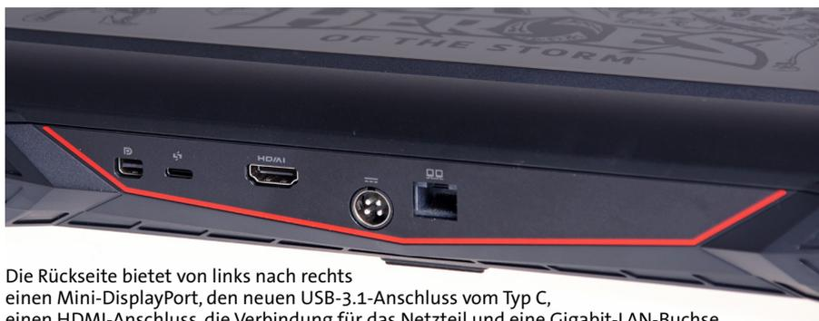
Die Rückseite bietet von links nach rechts einen Mini-DisplayPort, den neuen USB-3.1-Anschluss vom Typ C, einen HDMI-Anschluss, die Verbindung für das Netzteil und eine Gigabit-LAN-Buchse.
