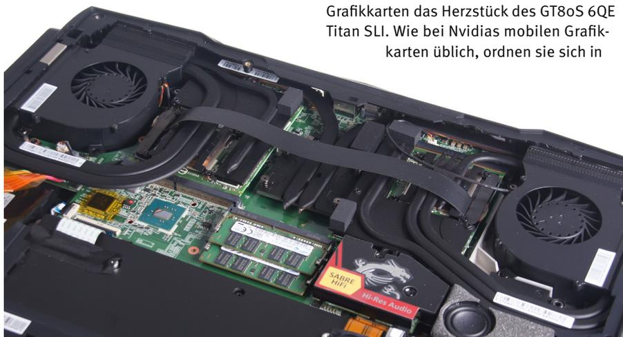
Nahezu alle Komponenten des MSI-Notebooks können Sie leicht erreichen. In der Mitte sehen Sie hier die CPU, daneben befinden sich die beiden GTX 980M-GPUs in Form von MXM-Modulen.
