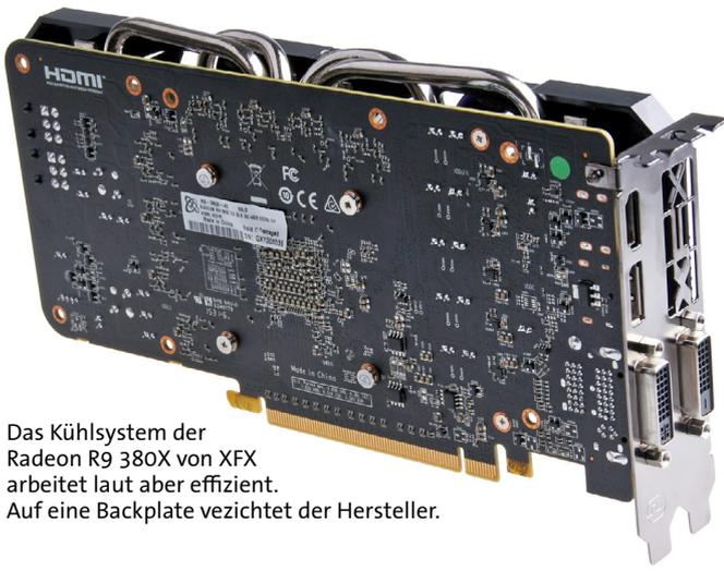
Das Kühlsystem der Radeon R9 380X von XFX arbeitet laut aber effizient. Auf eine Backplate verzichtet der Hersteller.
