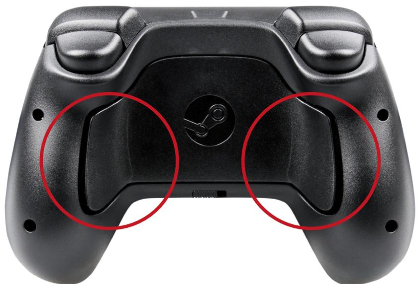
Ähnlich wie Microsofts neuer Xbox-Elite-Controller besitzt der Steam Controller zwei Griff-Tasten an der Unterseite, die sich bequem erreichen und bedienen lassen.
