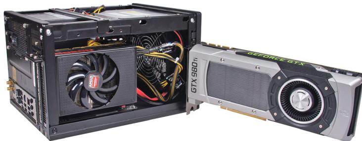
Eine ausgewachsene GeForce GTX 980 Ti bietet mehr Leistung pro Euro als die R9 Nano, passt aber längst nicht in alle Mini-ITX-Gehäuse.
