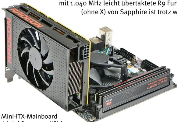
Ein Mini-ITX-Mainboard samt Intel-Prozessor, Kühler und Speicher sowie allen gängigen Anschlüssen passt perfekt zur kompakten Radeon R9 Nano. Das Gespann bietet die momentan beste Kombination aus sehr hoher Spieleleistung und geringem Platzbedarf.
