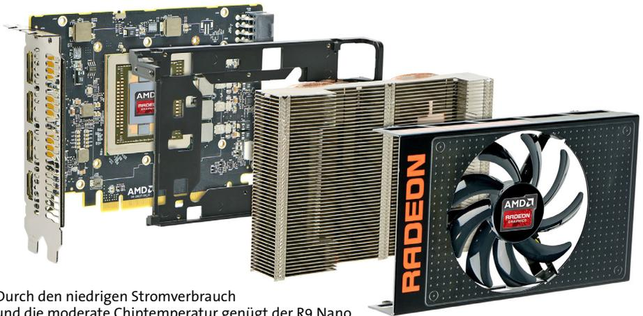
Durch den niedrigen Stromverbrauch und die moderate Chiptemperatur genügt der R9 Nano ein einzelner Lüfter. In Kombination mit Kühlplatte und -körper macht der seine Sache durchweg gut und wird nie nervig laut.
