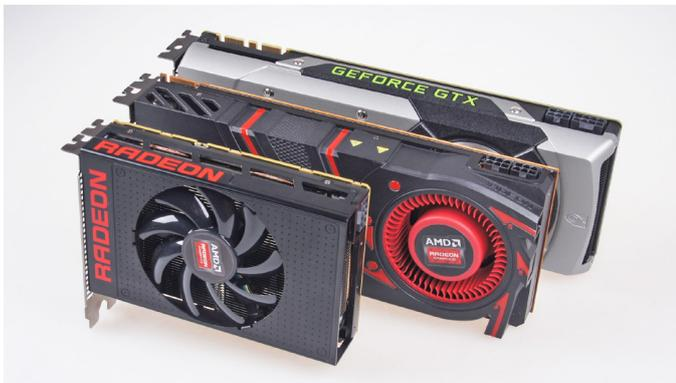
Im Vergleich zur GTX 980 (hinten) und R9 270X (Mitte) ist die Nano mit einer Länge von nur 15 cm deutlich kürzer – und trotzdem schneller.
