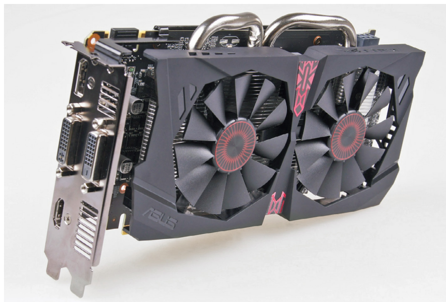
Asus erhöht die GPU-Taktrate der Geforce GTX 950 und stattet sie mit dem Strix-Kühlsystem aus. Dadurch arbeitet die Karte im Leerlauf komplett geräuschlos.
