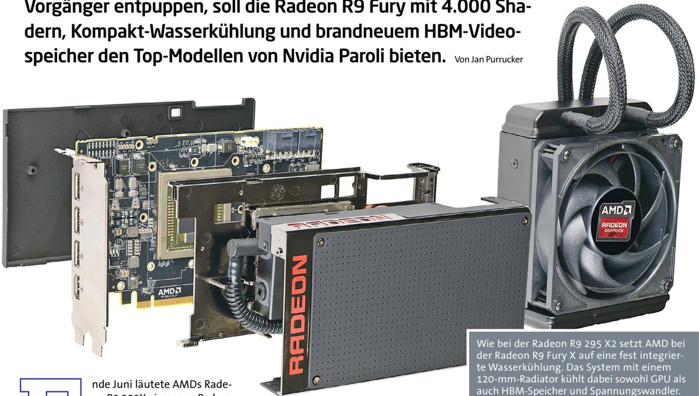
Wie bei der Radeon R9 295 X2 setzt AMD bei der Radeon R9 Fury X auf eine fest integrierte Wasserkühlung. Das System mit einem 120-mm-Radiator kühlt dabei sowohl GPU als auch HBM-Speicher und Spannungswandler.
