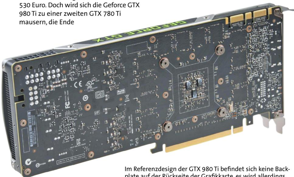
Im Referenzdesign der GTX 980 Ti befindet sich keine Backplate auf der Rückseite der Grafikkarte, es wird allerdings auch veränderte Herstellerdesigns geben.
