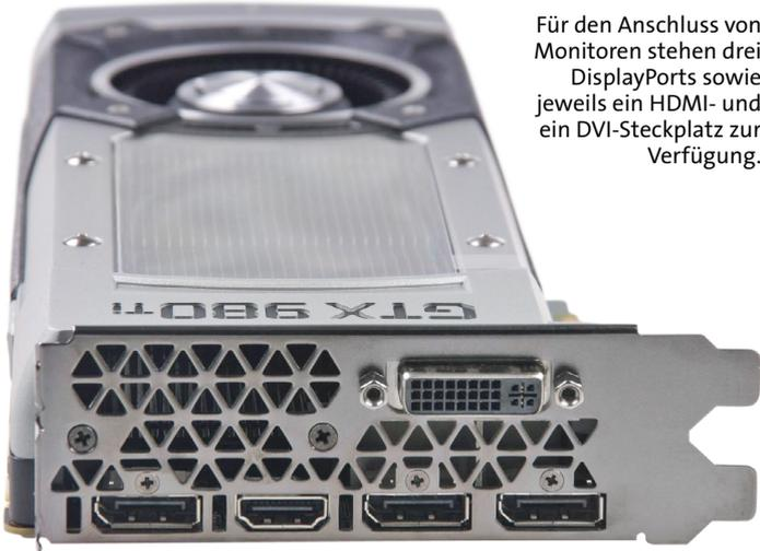
Für den Anschluss von Monitoren stehen drei DisplayPorts sowie jeweils ein HDMI- und ein DVI-Steckplatz zur Verfügung.
