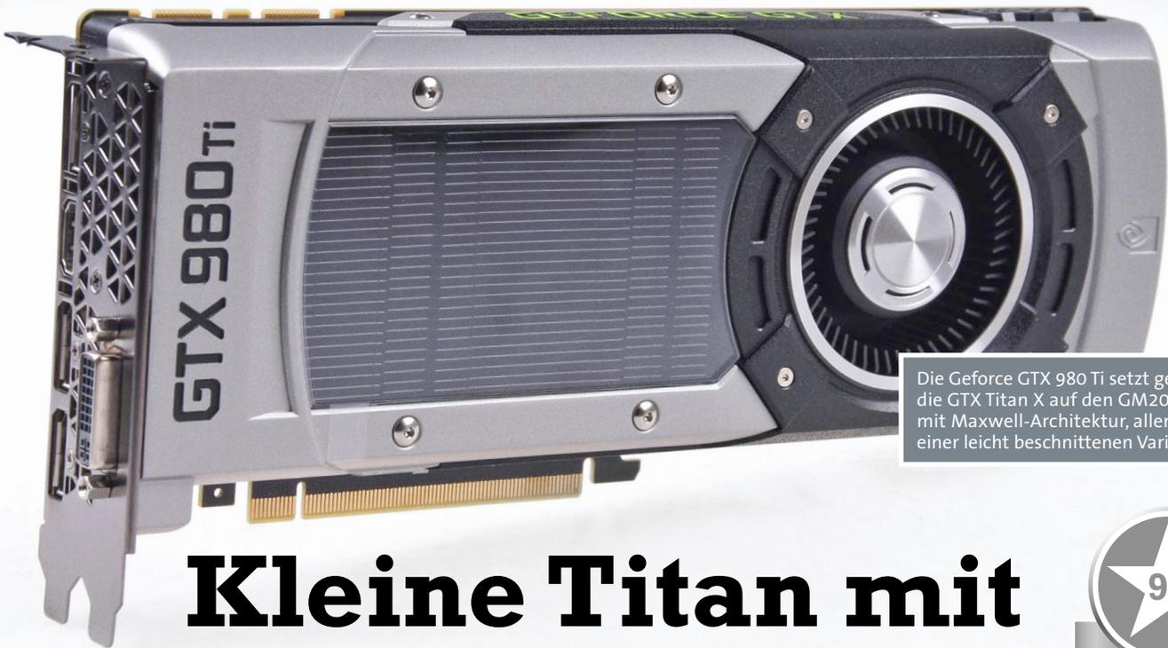
Die Geforce GTX 980 Ti setzt genau wie die GTX Titan X auf den GM200-Chip mit Maxwell-Architektur, allerdings in einer leicht beschnittenen Variante.
