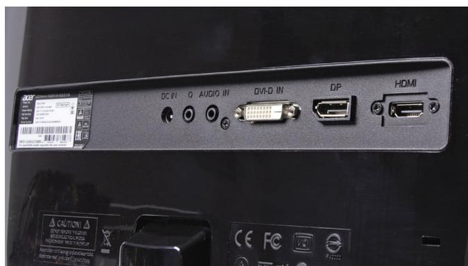
Alle wichtigen Anschlüsse von HDMI über DVI bis hin zu DisplayPort sind vorhanden und auch ein Headset lässt sich anschließen.
