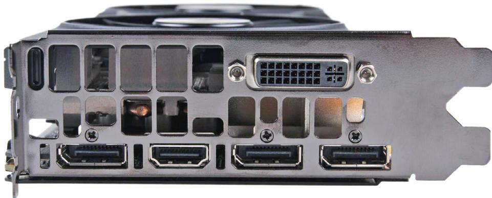
An den DVI, den HDMI und die drei Displayport-Anschlüsse können Sie insgesamt bis zu fünf Monitore anschließen, gleichzeitig betreiben lassen sich jedoch nur vier.
