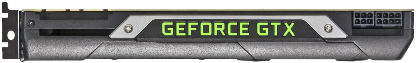
Strom erhält die GeForce GTX Titan X über einen 6- und einen 8-Pol-Stecker. Laut Nvidia liegt die TDP wie schon bei der ersten GTX Titan bei 250 Watt.
