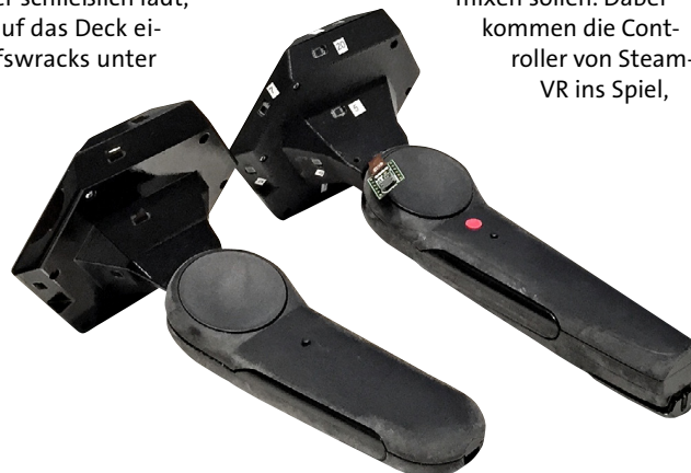
Die mit Touchpads ausgestatteten VR-Controller ermöglichen es SteamVR, mit Hilfe der Lasersensoren unsere Handposition und Ausrichtung zu erfassen, um mit der virtuellen Welt interagieren zu können.
