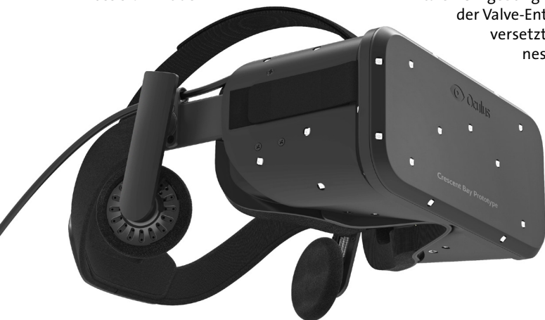
Der Rift-Prototyp »Crescent Bay« von Oculus ähnelt HTC Vive technisch sehr, nur bei der Positionserfassung geht Oculus VR einen anderen Weg: Sie erfolgt über Infrarot-LEDs und nicht über Laser.
