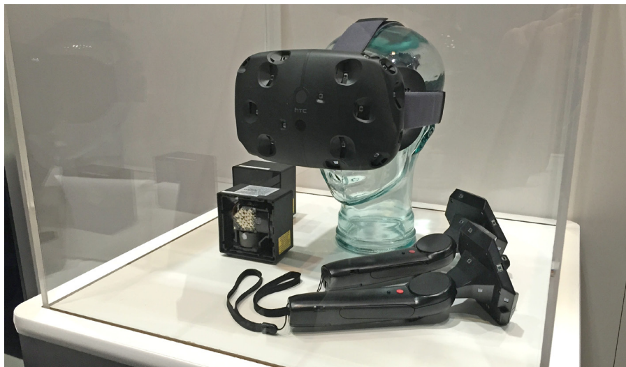
Die Hardware für SteamVR besteht aktuell aus der VR-Brille »Vive« von HTC, den stabförmigen SteamVR-Controllern und zwei rechteckigen Boxen zur Positionserfassung namens »Lighthouse«.
