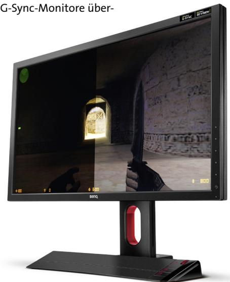
Zu den Extras des XL2420G gehört der Black Equalizer. Er soll dunkle Bereiche aufhellen, ohne das Bild insgesamt zu hell werden zu lassen. Links ist er deaktiviert, rechts auf der höchsten Stufe, die etwas zu viel des Guten ist.
