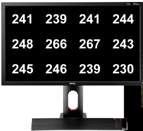
Die Werte geben in  $\text{cd/m}^2$  an, wie hell der Monitor im jeweiligen Bereich maximal wird. In der Mitte des Bildschirms erreicht der XL2420G naturgemäß die höchste Helligkeit.
