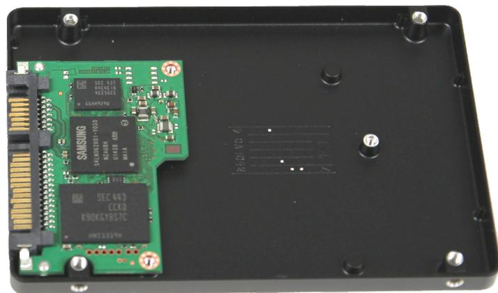
Wie wenig Platz Speicherchips mit TLC-Modulen brauchen, zeigt die äußerst kleine Platine der SSD 850 Evo mit 120 GByte.
