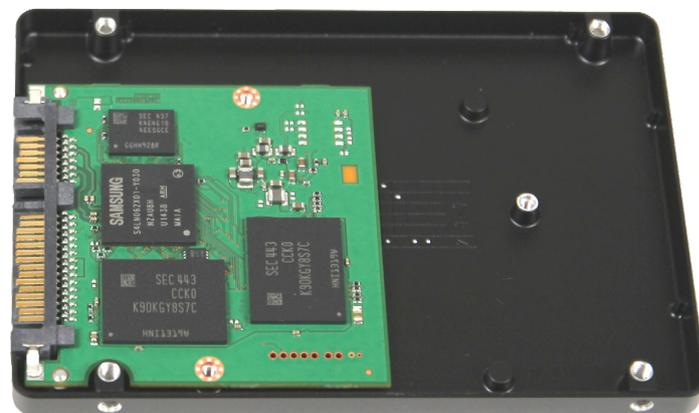
Die SSD 850 Evo mit 500 GByte Speicherplatz benötigt sichtlich mehr Raum für die Unterbringung der nötigen Flash-Chips.
