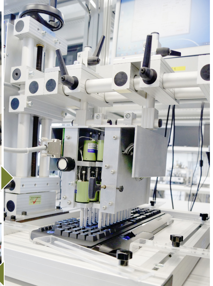
Statt die Tasten in vergleichsweise normalem Tempo zu betätigen, werden sie hier bewusst möglichst schnell hintereinander gedrückt, um ihre Haltbarkeit zu ermitteln.
