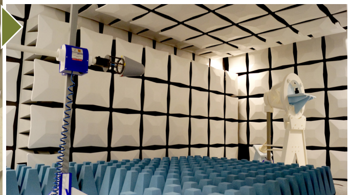
Im Inneren dieses Raumes sind alle Funkverbindungen von außen abgeschottet. So lässt sich die Sende- und Empfangsleistung von kabellosen Mäusen und Headsets unverfälscht (aber realitätsfern) ermitteln.
