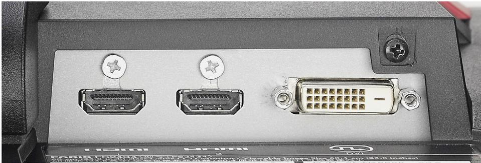
Um den Eizo FS2434 auch als Fernseher oder zusammen mit einer Konsole nutzen zu können, stehen neben dem DVI-Anschluss auch zwei HDMI-1.4-Ports zur Verfügung.
