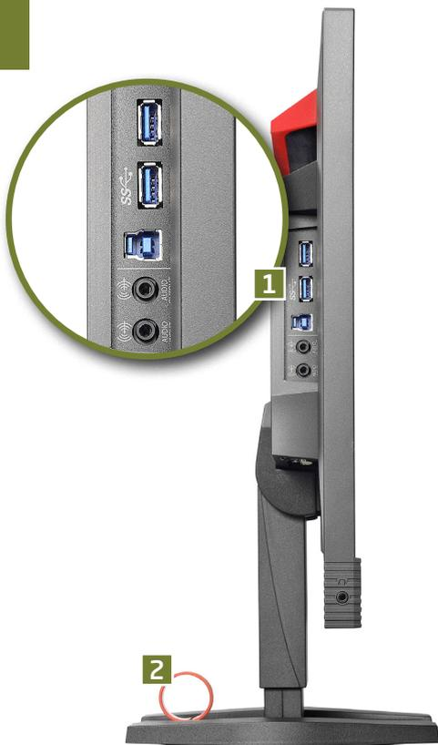
An der Seite des FS2434 finden sich zwei USB-3.0-Anschlüsse, Audio-In- und Out sowie ein Steckplatz für Kopfhörer. Der rote Ring auf dem Standfuß dient als Kabelführung.
