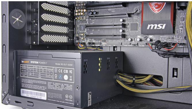
Nur Grey (links) verbaut ein Netzteil ohne abnehmbare Kabel, alle anderen Hersteller wie etwa Mifcom (rechts) nutzen modulare Modelle.
