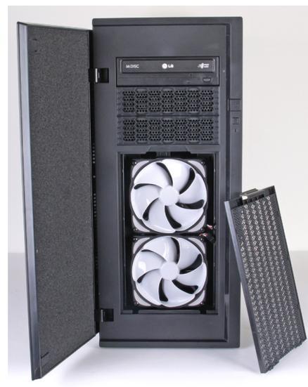
Viele der verwendeten Gehäuse wie etwa das Coolermaster Silencio 652S beim Rechner von Kiebel verfügen über abnehmbare Staubfilter.
