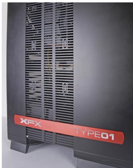
Die Lüftungsschlitze beim Big-Melon-PC sorgen für gute Durchlüftung, dadurch dringen aber auch mehr Geräusche nach außen.
