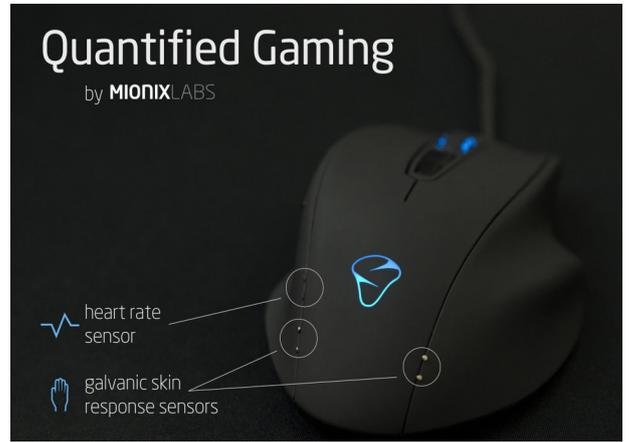
Mit ihren integrierten Sensoren soll die Mionix Naos QG beim Spielen die Herzfrequenz und die Oberflächenspannung der Haut messen. Via Software lassen sich die Daten auswerten.
