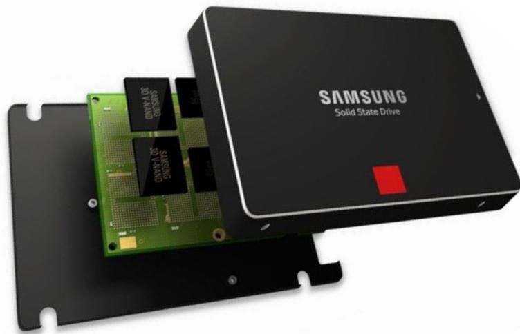
SSDs setzen viele Mechanismen ein, um mit hohen Schreibzugriffen gut umgehen zu können. Aktuelle Modelle wie die SSD 850 Pro von Samsung kommen dadurch auf eine zugesicherte Schreibleistung von 40 GByte pro Tag, die man bei normaler PC-Nutzung nie erreicht.
