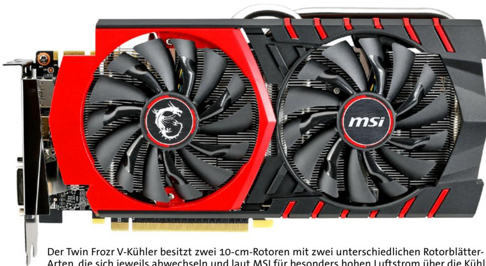
Der Twin Frozr V-Kühler besitzt zwei 10-cm-Rotoren mit zwei unterschiedlichen Rotorblätter-Arten, die sich jeweils abwechseln und laut MSI für besonders hohen Luftstrom über die Kühlrippen sorgen – die tollen Resultate bestätigen die Effizienz des Flüsterkühlers.
