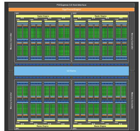
Die 2.048 Shader-Einheiten der GeForce GTX 980 verteilen sich auf vier Graphics Processing Cluster (GPC). Von denen jeder wiederum acht Streaming Multiprozessoren (SM) besitzt.
