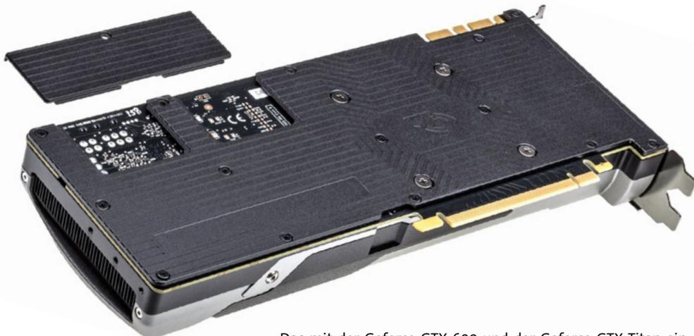
Das mit der GeForce GTX 690 und der GeForce GTX Titan eingeführte Aluminium-Gehäuse kommt auch bei der GeForce GTX 980 wieder zum Einsatz. Neu ist jedoch die schwarze Backplate, die sowohl die Stabilität als auch die Kühlung verbessern soll. Am hinteren Ende lässt sich ein kleines Rechteck der Platte entfernen, um bei SLI-Verbänden den Luftstrom und dadurch die Kühlung zu verbessern.
