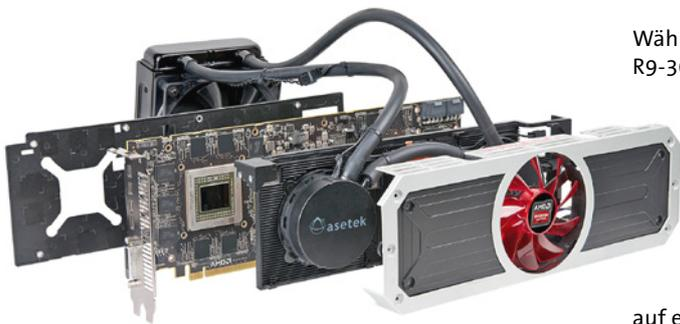
Angeblich setzt AMD zur Kühlung der Radeon R9 390X wie bei der Dual-GPU Karte R9 295 X2 auf eine Hybridlösung aus Luft- und Wasserkühlung von Asetek.
