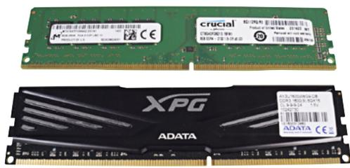
DDR4-Speicher (oben) ist nicht zu DDR3-RAM (unten) abwärtskompatibel. Die unterschiedlich platzierte Einkerbung zwischen den Kontakten verhindert den Einbau in einen falschen Slot.
