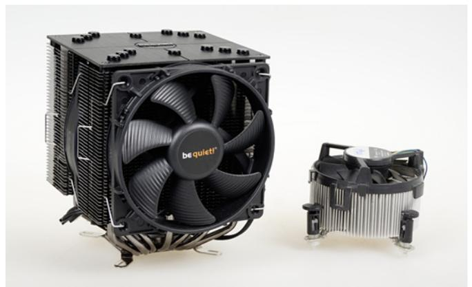
Prozessoren liegt in der sogenannten »Boxed«-Variante ein passender Kühler bei, rechts am Beispiel eines Modells von Intel zu sehen. Im Vergleich zu deutlich größeren Kühlern wie dem be quiet! Dark Rock Pro 3 (links) sind sie aber erheblich lauter und bieten meist die schlechtere Kühlleistung. Wenn es das Budget zulässt, sollten Sie deshalb einen separaten CPU-Kühler dazu kaufen.
