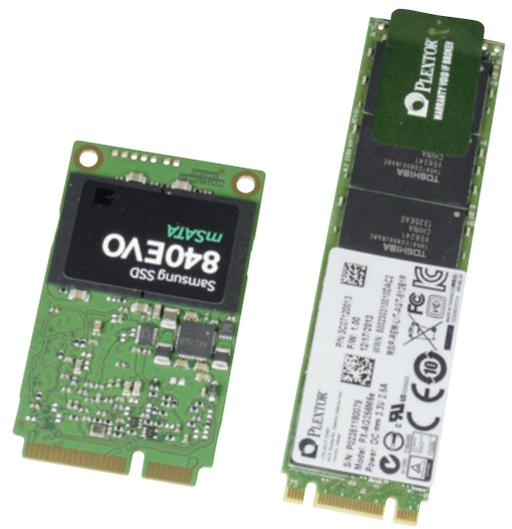
Die alte mSATA-Schnittstelle (links) wird ersetzt durch den **M.2-Anschluss** (rechts). Für Desktop-PC's sind die vergleichsweise teuren Mini-SSDs aber wenig interessant.
