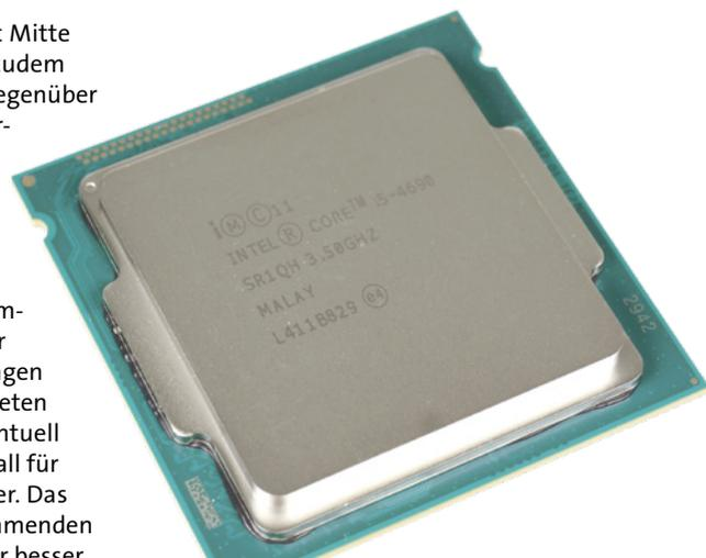
Bislang gibt es noch keine »K«-Varianten der neuen CPUs mit freiem Multiplikator. Die sollen Mitte Juni erscheinen und ein hochwertigeres Wärmeleitmaterial zwischen dem Chip und der »Heatspreader« genannten Metallabdeckung besitzen.
