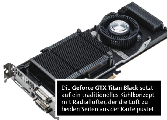
Die **GeForce GTX Titan Black** setzt auf ein traditionelles Kühlkonzept mit Radiallüfter, der die Luft zu beiden Seiten aus der Karte pustet.
