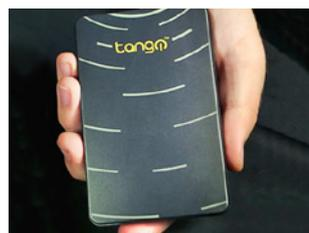
Sieht aus wie eine externe Festplatte, ist aber ein **kompletter Rechner**: Der Tango-PC verfügt über eine AMD-APU, 2,0 bis 8,0 GByte RAM und eine mSATA-SSD mit 32 bis 512 GByte Speicherplatz.
