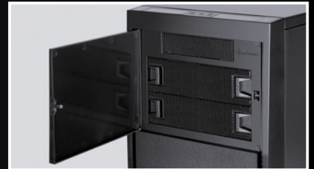
1x 3,5"-Einbauschacht (extern) 2x 5,25"-Laufwerksschächte (extern)
